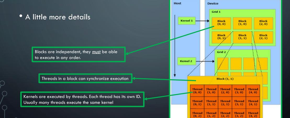
Picture from <a href="http://geco.mines.edu/tesla/cuda\_tutorial\_mio/">http://geco.mines.edu/tesla/cuda\_tutorial\_mio/</a>
